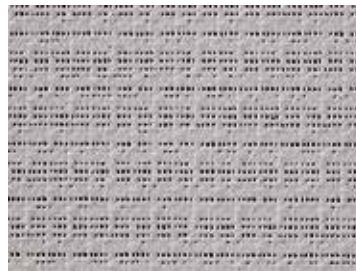
Polyestergewebe Gewebe aus hochfesten Polyesterarnen, vorgereckt und PVC-fixiert
